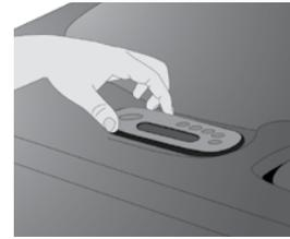
Ziehen Sie die doppelseitige Schutzschicht von der Rückseite der Tastatur ab.
