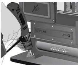
Entfernen Sie die 2 Schrauben, welche die Vorderseite der Gerätebasis auf dem SPA Boden halten.
