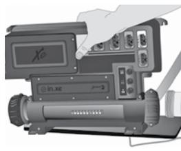
Lösen Sie die 2" Heizermuttern von beiden Enden der SPA Verrohrung. Lösen Sie die in.xe SPA Pack, indem Sie die Einheit vom Leitblech, welche die Rückseite der Gerätebasis hält, weg schieben.
