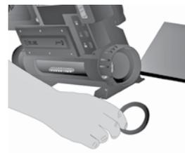
Platzieren Sie einen 2" Gummidichtungsring an das Ende jeder Heizermutter, um Leckwasser zwischen den Heizermuttern und den 2" PVC Heizer Schlussstück zu vermeiden.
