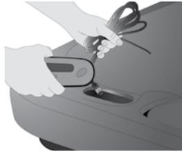
Führen Sie das Kabel der neuen Tastatur durch die Lochöffnung der SPA.
