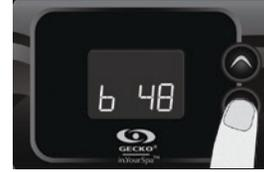
Los valores mostrados por el sistema corresponden al 80% del amperaje máximo del disyuntor diferencial de fuga a tierra (GFCI/RCD).
