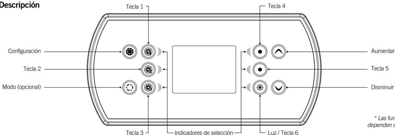
\* Las funciones de las teclas 1 a 5 dependen de la configuración a nivel inferior de su sistema
