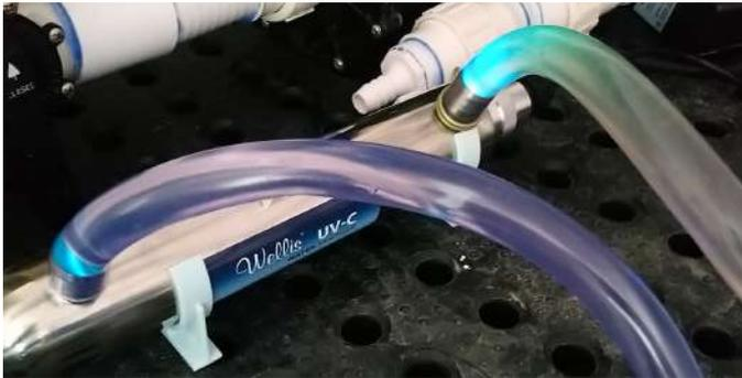
Lorsque l'ampoule UV-C ne fonctionne plus, la led devient rouge et le transformateur se met à bipper. Remplacez alors l'ampoule UV-C.
