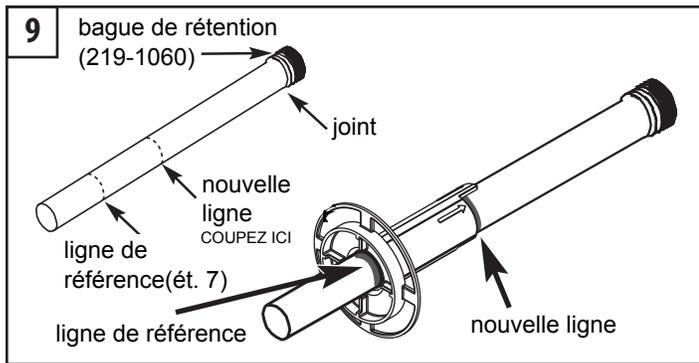
9. Retirez le tuyau d'1" de la douille et réalignez l'outil de mesure avec la ligne de référence. Tracez une nouvelle ligne juste derrière les flèches indiquées sur l'outil de mesure.
