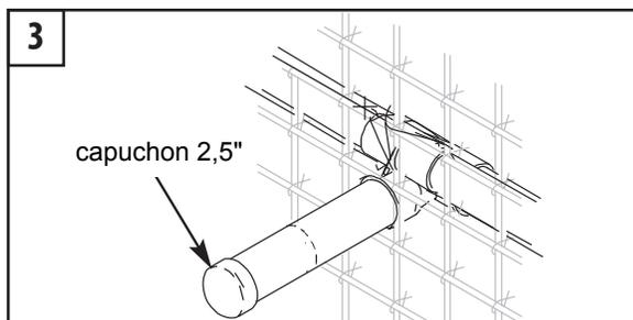
3. Collez un capuchon de 2,5" sur l'extrémité du tuyau pour tester la pression avant de couler le béton.
