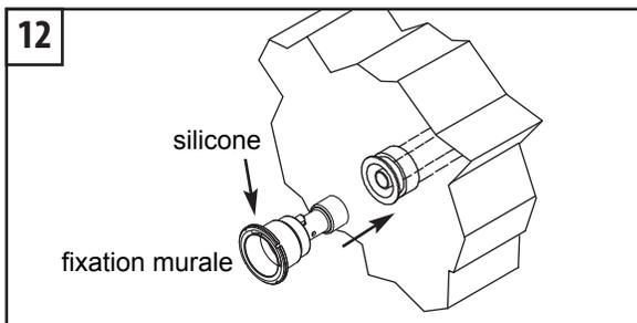
12. Appliquez du silicone transparent tout autour de la face arrière de la collerette de la fixation murale. Décapez et collez l'extrémité du tuyau de 1" et l'extrémité de la fixation. Faites glisser la fixation sur l'extrémité du tuyau d'1" jusqu'à ce qu'elle soit serrée contre le support de buse.
