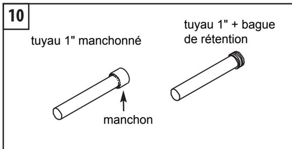
10. Créez une tuyauterie d'1" avec un manchon pour installer l'assemblage de tuyaux dans les étapes suivantes.
