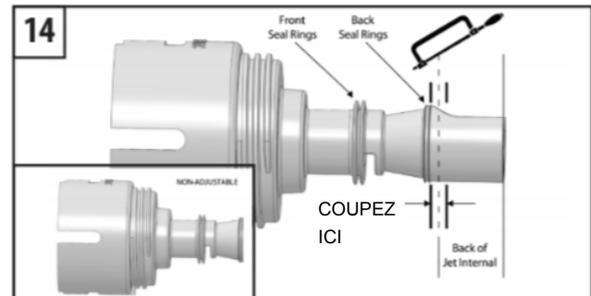
14. Pour fabriquer une buse non-réglable, coupez l'arrière du diffuseur après les bagues d'étanchéité arrière.
