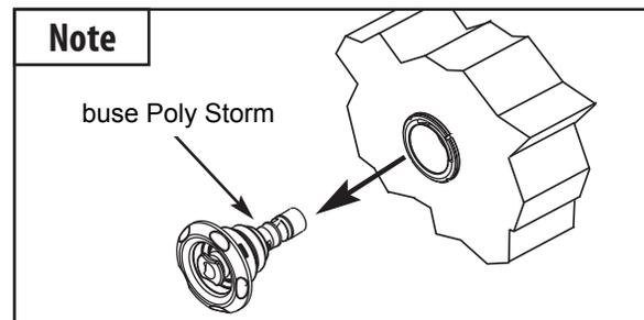
Note : En période d'hivernage, retirez UNIQUEMENT la buse de la fixation murale. Installez un bouchon d'expansion en caoutchouc n°10 à l'intérieur de l'ouverture de la fixation.
