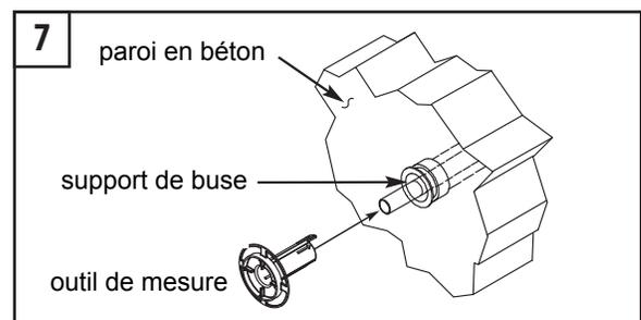
7. Insérez le tuyau d'1" (bague de rétention vers la paroi) dans le support et jusqu'à la douille, et vissez-le. Faites glisser l'outil de mesure (218-1960A) sur l'extrémité du tuyau jusqu'à ce qu'il affleure le support.
