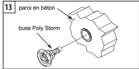
13. Insérez une buse Poly Storm dans la fixation murale et vissez jusqu'à la première butée. Ne forcez pas. Pour réduire le débit d'eau, tournez dans le sens des aiguilles d'une montre. Inversement pour augmenter le débit d'eau. Pour retirer la buse, continuez à tourner dans le sens inverse des aiguilles d'une montre après la butée. Vous entendrez un claquement pour confirmer la libération de la buse.
