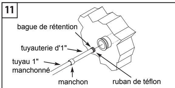
11. Posez 4 à 6 couches de ruban de téflon autour de la bague de rétention, dont une couche sur le joint torique. Ajustez à sec le tuyau d'1" manchonné sur l'extrémité du tuyau 1" et sa bague de rétention. Vissez l'ensemble dans le corps jusqu'à ce qu'il soit bien ajusté et que le tuyau manchonné tourne librement. Retirez ensuite le tuyau manchonné de l'extrémité de la tuyauterie d'1".
