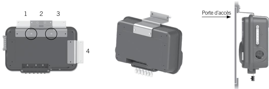
L'attache en Z en aluminium est conçue pour permettre de monter le système de contrôle de façon qu'il se trouve juste derrière le cadre de la porte d'accès aux contrôles. Pour plus de souplesse, l'attache peut être vissée au système de contrôle à quatre endroits différents.
