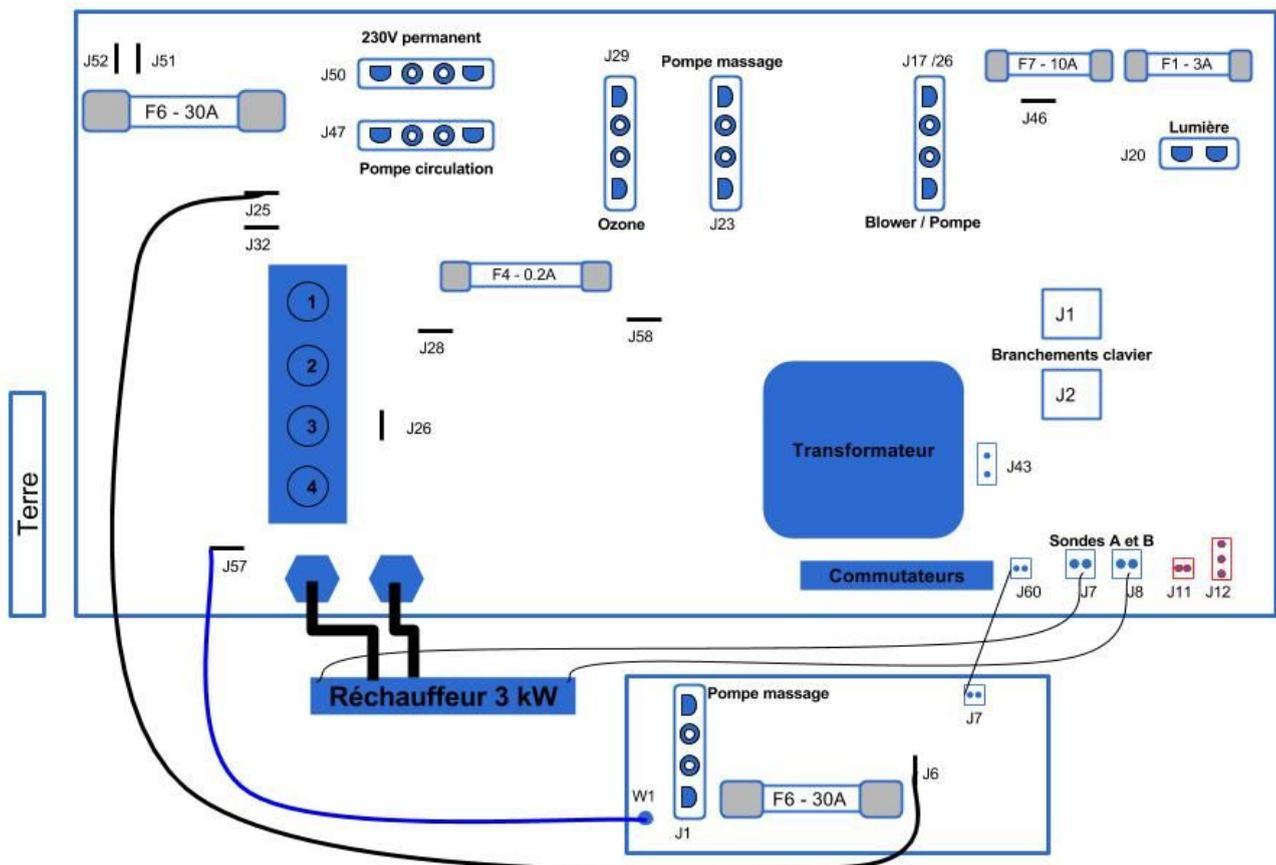
La pompe de massage branchée sur la carte d'extension doit être à une vitesse
