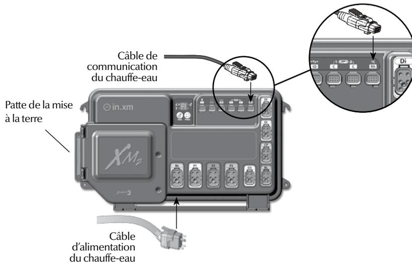
Raccordez le câble d'alimentation du chauffe-eau au connecteur de sortie in.link identifié « Rh » sur le Spa Pack.
